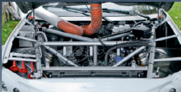
Fotele i pasy są bardzo wygodne. Pedaly wbudowano w podłogę (niższy środek ciężkości). Niżej: rury dolotu powietrza.
