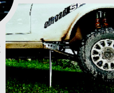
Opel Mokka klasy T1, zbudowany dla Nuno Matosa. Z lewej: haldy i wyświetlacz temperatur. Z prawej: dwustronny lewerek hydrauliczny.
