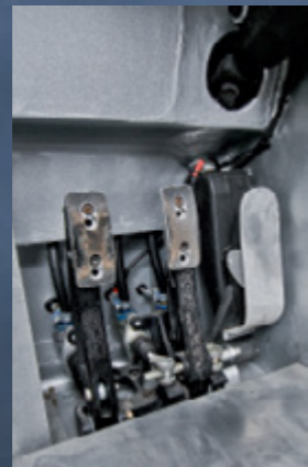
Fotele i pasy są bardzo wygodne. Pedaly wbudowano w podłogę (niższy środek ciężkości). Niżej: rury dolotu powietrza.
