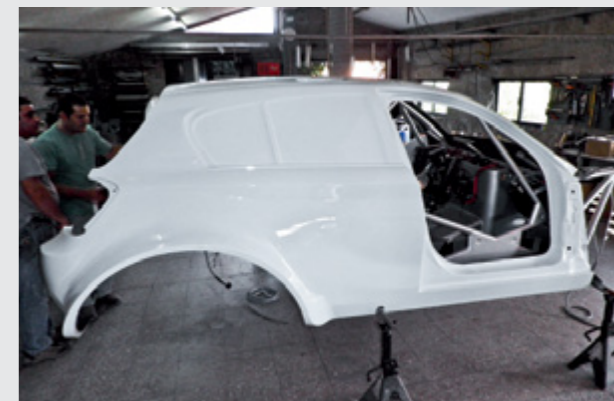
Nadwozie wykonano z laminatu. Kształtem przypomina karoserię BMW serii 1. Fotel ustawiono optymalnie dla kierowcy już w czasie budowy klatki, później dokonywano tylko korekt. Koszt budowy kompletnego samochodu to 180 tys. euro.
