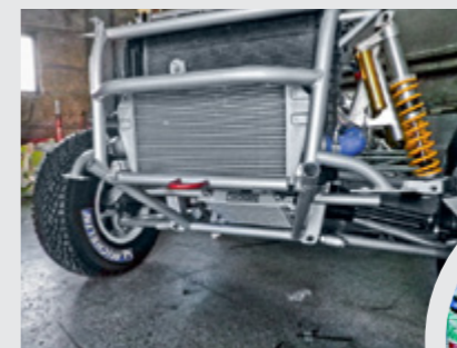
Chłodnice wody, oleju dyferencjału i układu kierowniczego, intercooler. Z prawej: 6-biegowa skrzynia Sadev.
