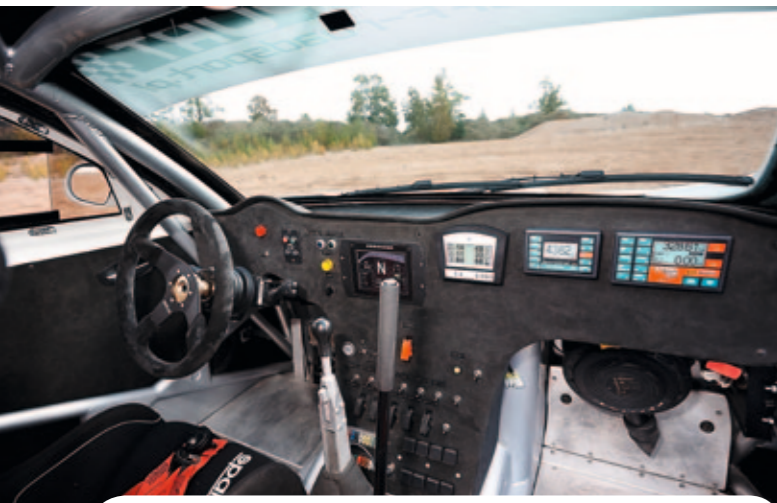
Kokpit pojazdu uproszczony do granic możliwości, dwa wyświetlacze informujące o parametrach podzespołów
