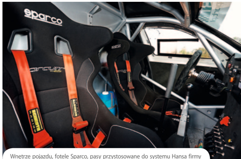
Wnętrze pojazdu, fotele Sparco, pasy przystosowane do systemu Hansa firmy Schroth
