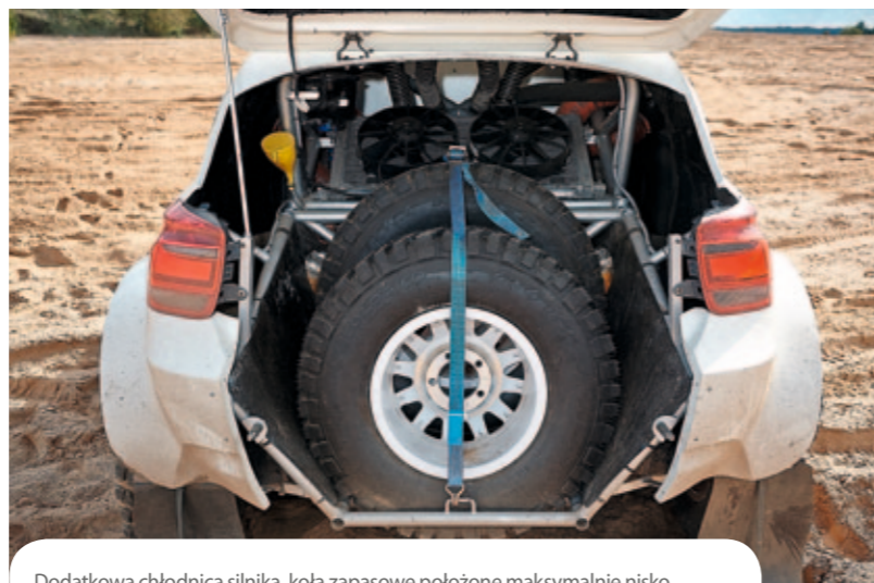
Dodatkowa chłodnica silnika, koła zapasowe położone maksymalnie nisko
