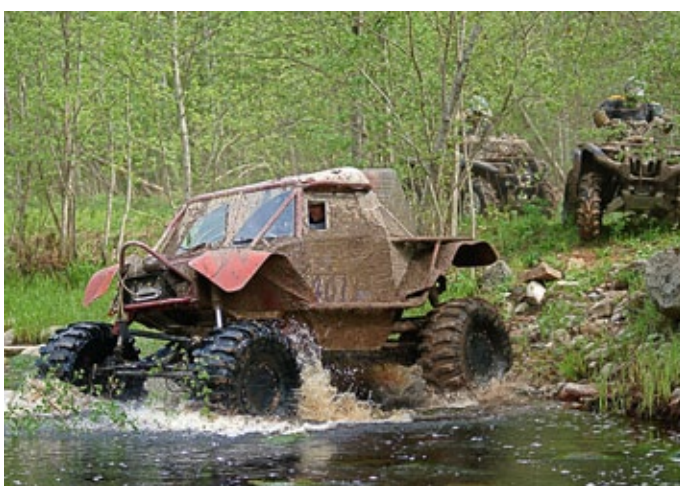
▲ Zwycięski pojazd klasy Proto z silnikiem Corvette 550 KM i układem skrętnych osi
