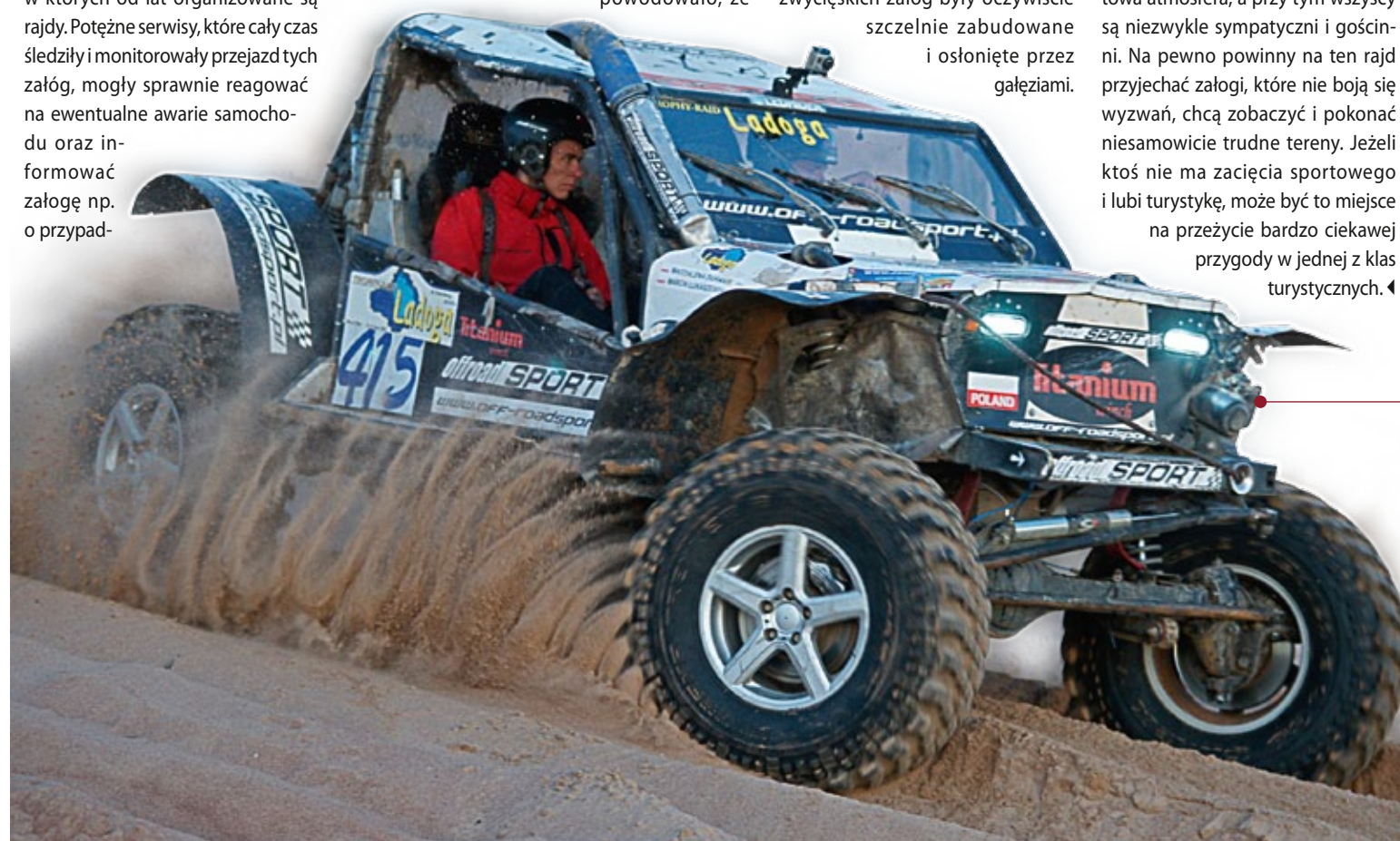
▲ Zwycięski pojazd klasy Proto z silnikiem Corvette 550 KM i układem skrętnych osi
